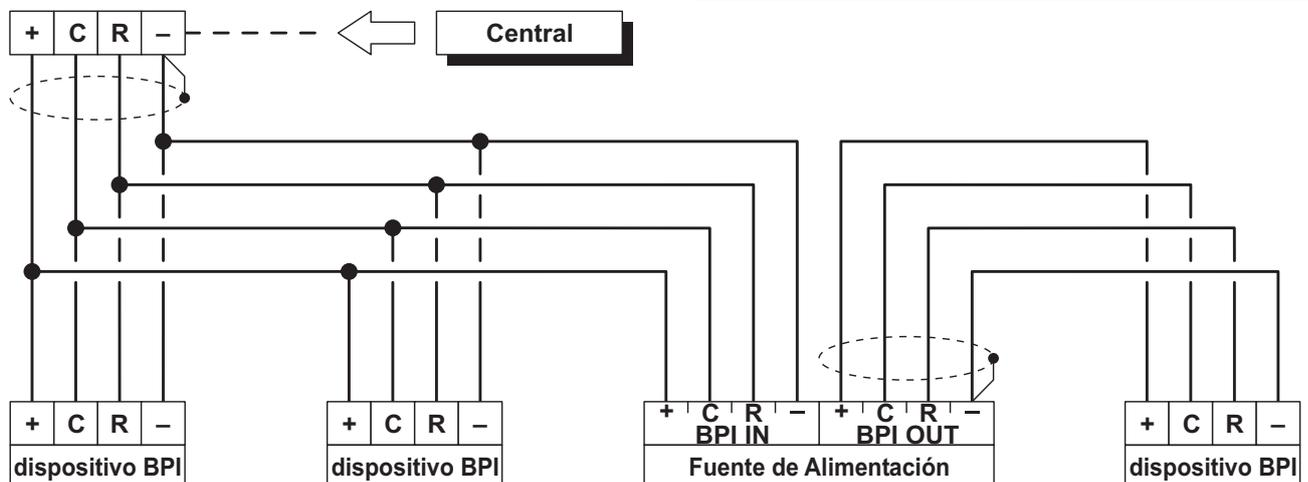
**Figura 9** Conexión de 4 Dispositivos BPI.
