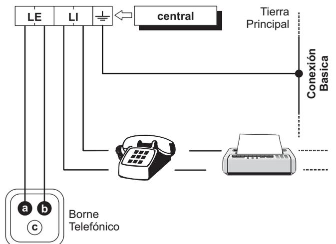
**Figura 21** Conexión de la línea telefónica a la Central.
