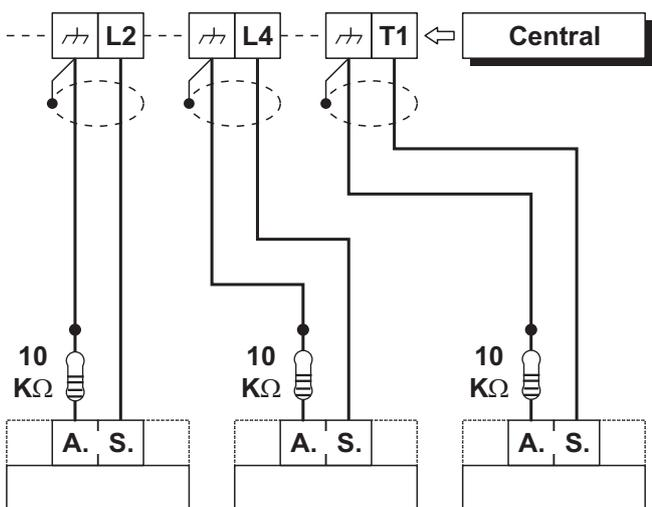
**Figura 20** Conexión de tres contactos anti-sabotaje a tres zonas tipo 24h con SEOL Supervisada, los bornes [A.S.] son el contacto anti-sabotaje, Normalmente Cerrado, del dispositivo.
