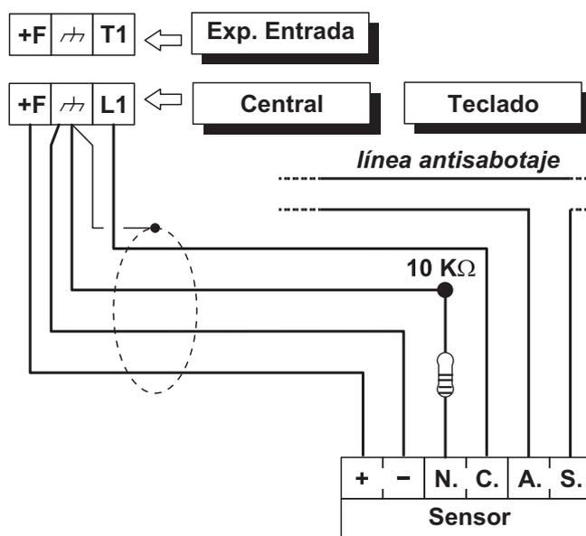
**Figura 12** Conector de un sensor a una Zona con Balance 10 K o 10 K sólo alarmas SEOL supervisión.
