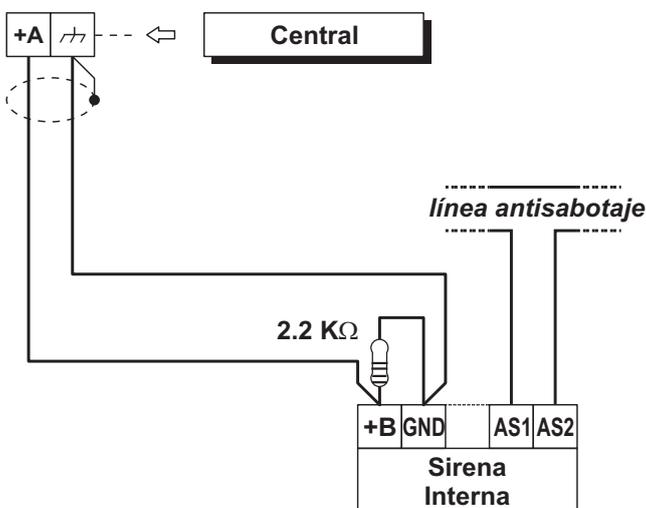
**Figura 18** Conexión de una Sirena Interna a una salida Supervisada por la Centrale.
