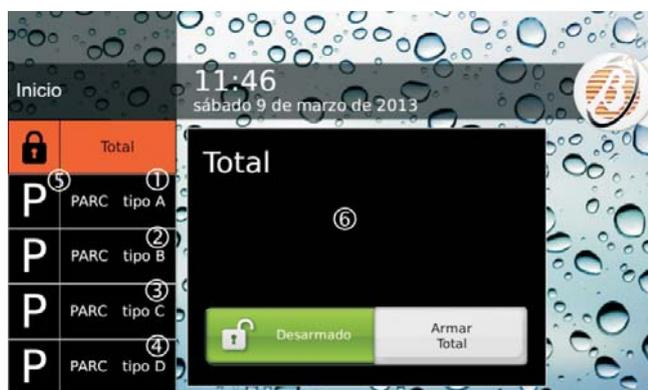
**Figura 28** Inserción con teclado Touch: Las etiquetas 1, 2, 3 y 4 pueden personalizarse como explicado en el texto, en la posición 5 se colocará la letra inicial de la inserción Especial correspondiente; en la ventana 6 aparecerá la descripción asignada a la inserción seleccionada como se explica en el texto.
