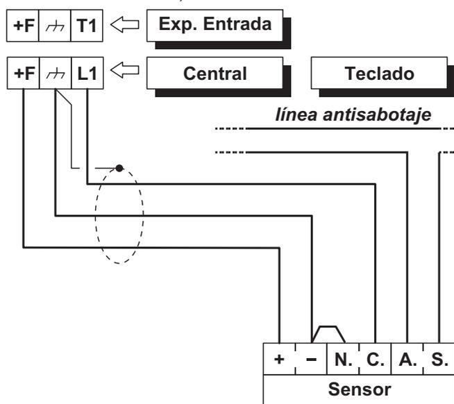
**Figura 11** Conexión de un sensor a una Zona con Balance Normalmente Cerrado (supervisión).
