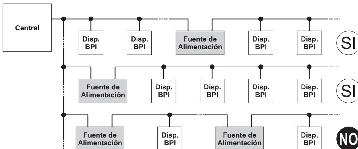
Figura 10 Conexión de las Fuentes de Alimentación
