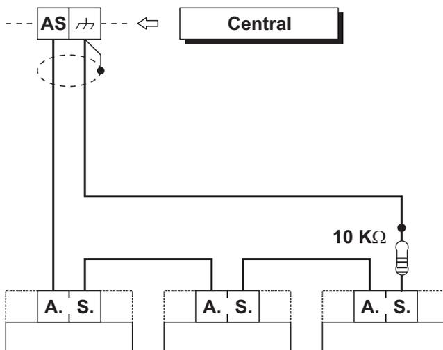
**Figura 19** Antisabotaje de la central: Los bornes [A.S.] son el Contacto Antisabotaje, Normalmente cerrado, del Dispositivo.
