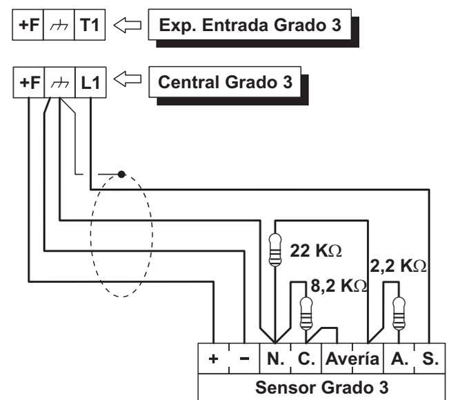
**Figura 14** Conexión de un sensor 3 a una Zona con el Conexión Triple End of Line.
