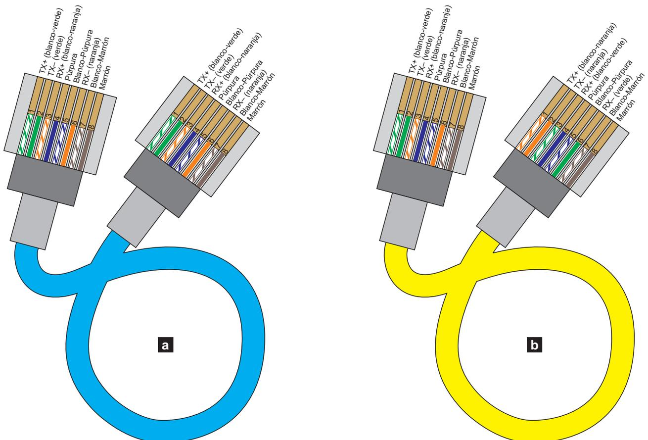
**Figura 8** Diagrama de los cables Ethernet “directo” (a) y “cruzado” (b).
