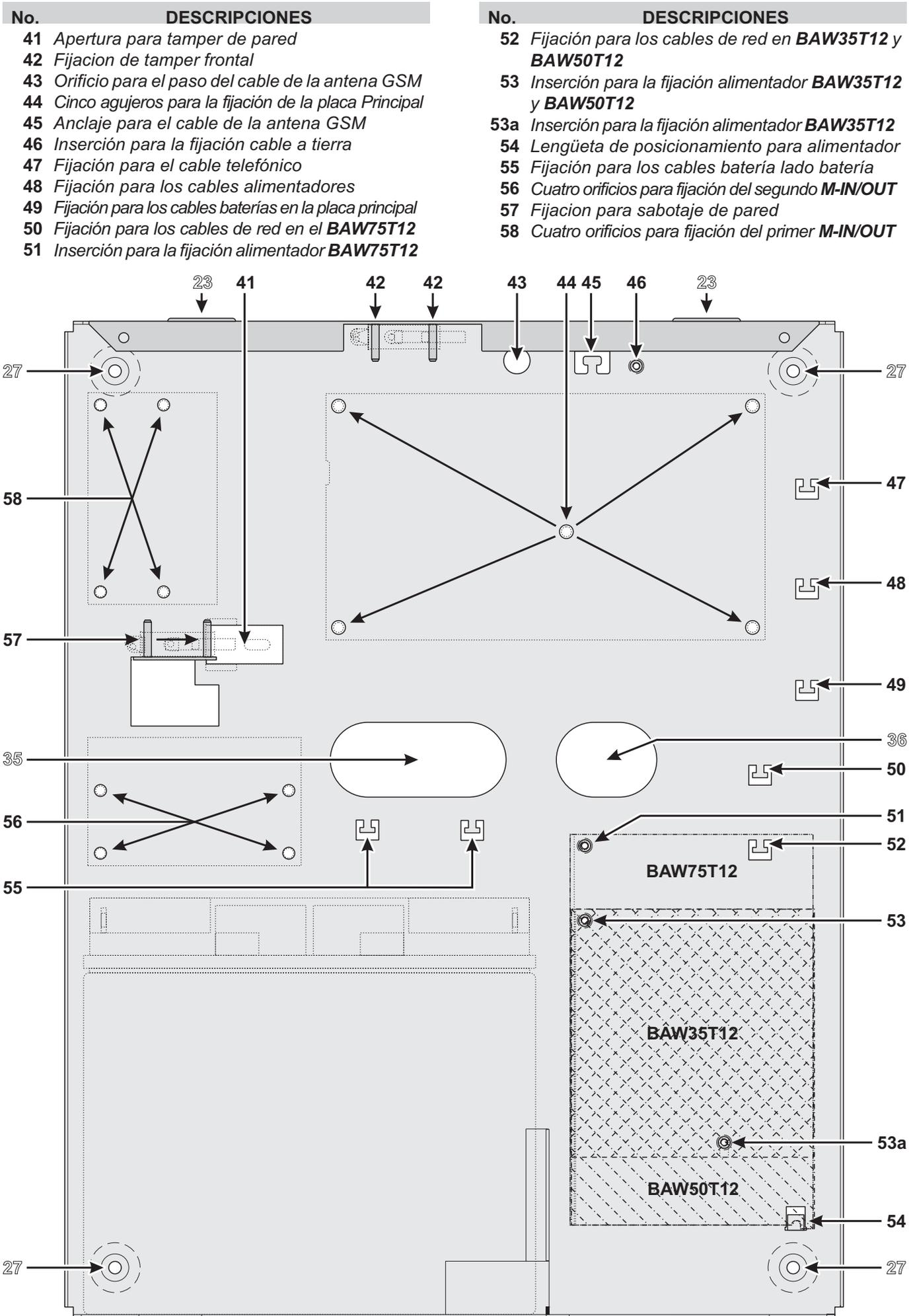
Figura 4 Fijación del contenedor Metálico.
