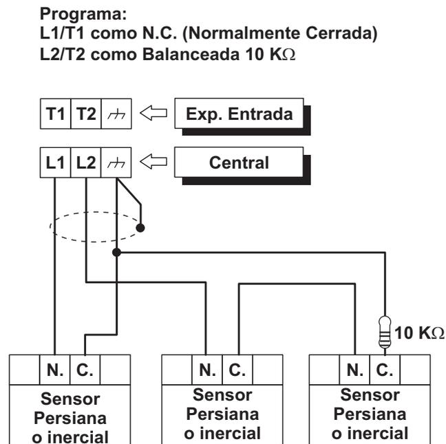
**Figura 15** Conexión de sensores Inerciales (sólo para las zonas de la central) y Contactos para Persianas: conexión de un sensor a una zona N.C. de dos sensores a una zona Balanceada 10K.
