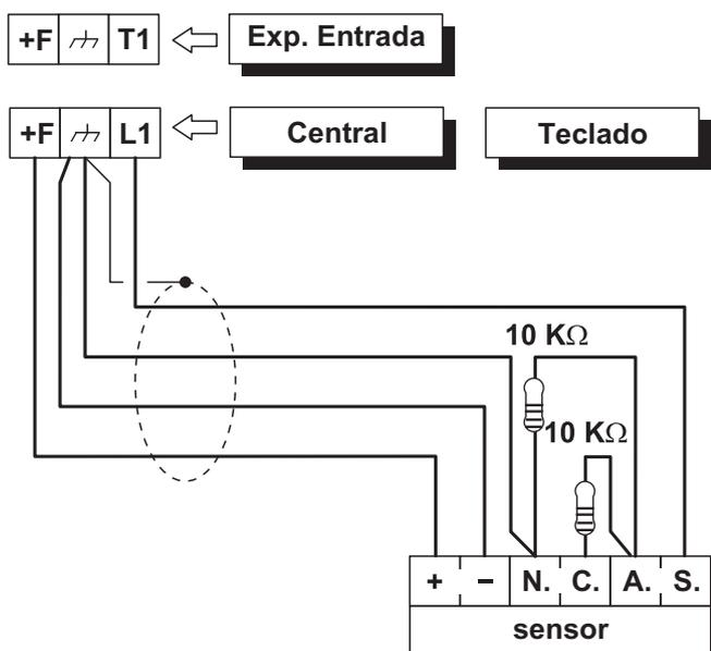
**Figura 13** Conexión de un sensor a una Zona con Balance Normalmente Doble (DEOL supervisión).
