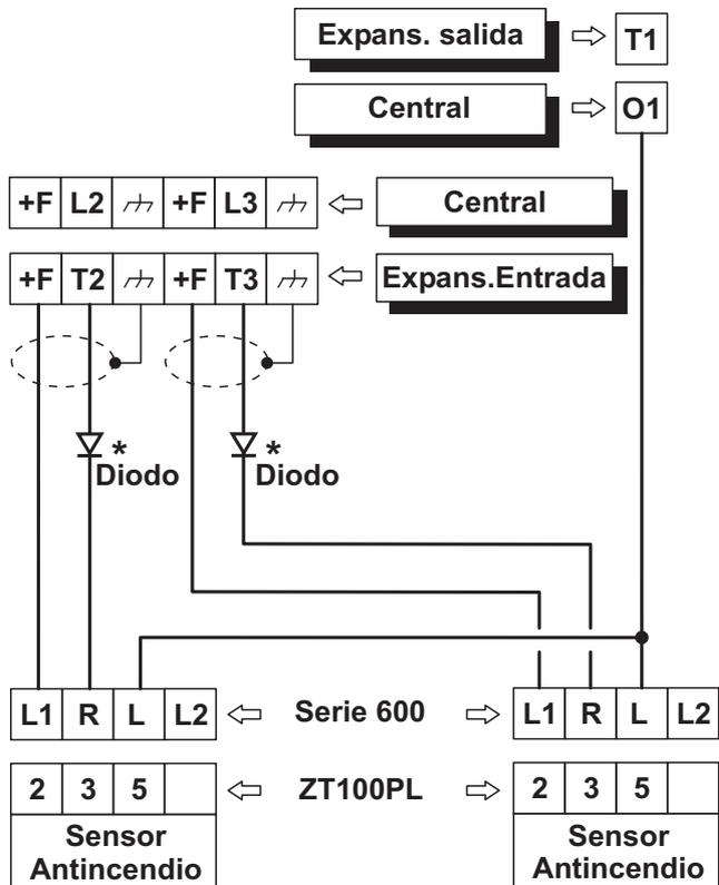
**Figura 16** Conexión de 2 sensores antiincendio a zonas con Balance Normalmente Abierto (\* Sólo con la serie 600).
