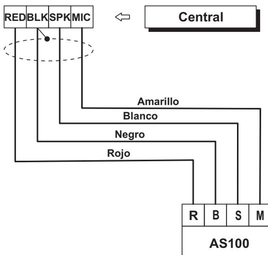
Figura 22 Conexión de l'AS100 a la central.
