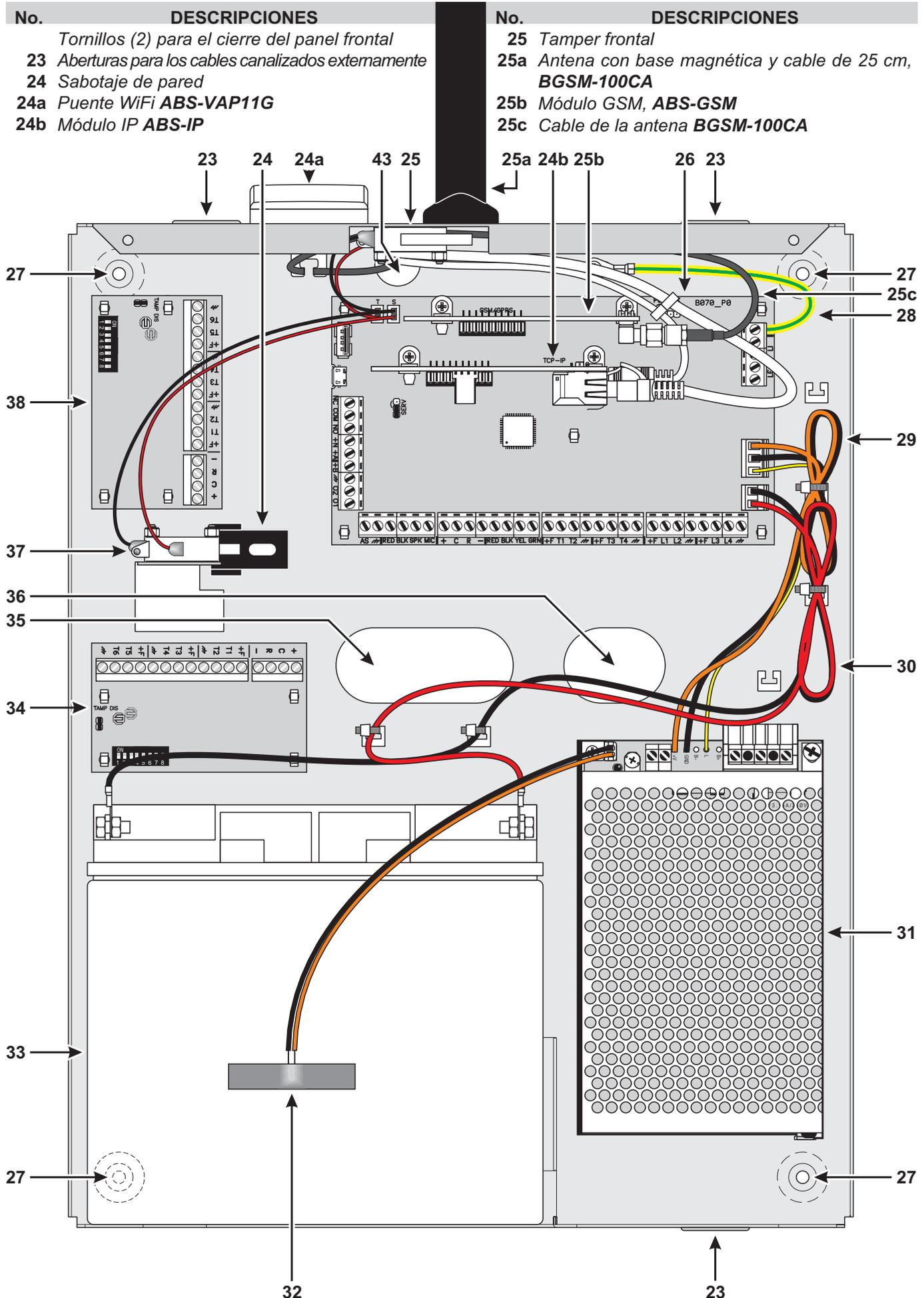
Figura 2 Partes de la central ABSOLUTA Plus en el contenedor metálico.
