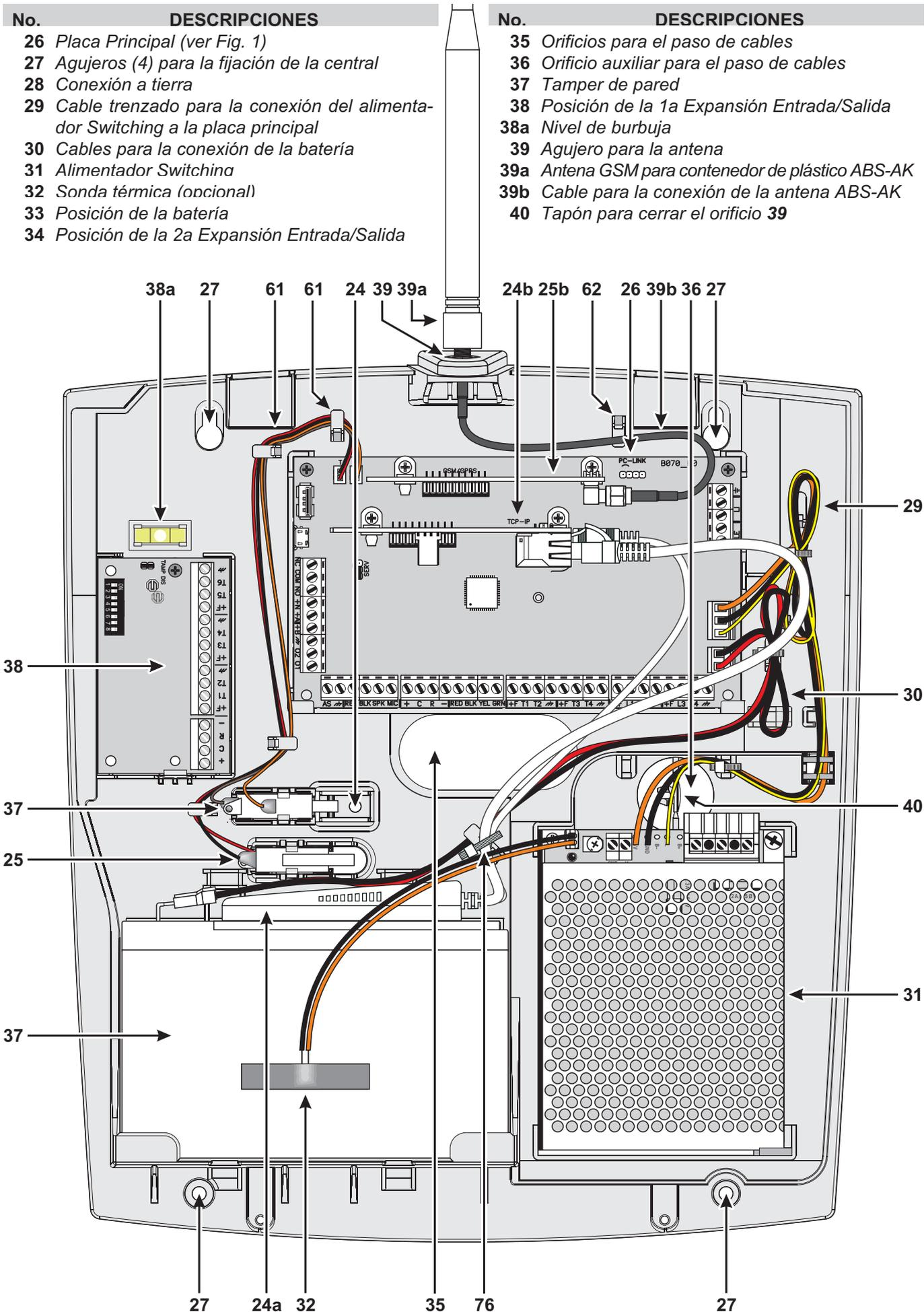
Figura 3 Partes de la central ABSOLUTA Plus en el contenedor plástico.
