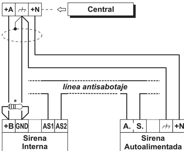
**Figura 17** Conexión de una Sirena Autoalimentada y de una Sirena Interna a la Salida n° 1 de la Centrale.
