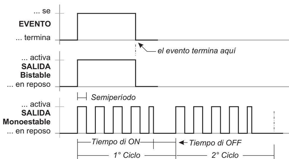
**Figura 27** Efecto de los parámetros de Semiperíodo y Ciclos en las salidas Biestable y Monoestable.
