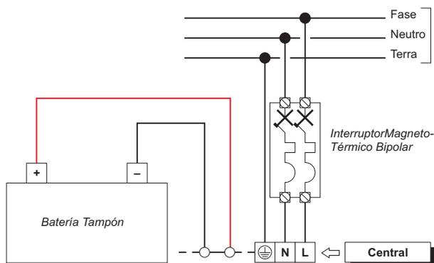
Figura 24 Conexión de la alimentación.
