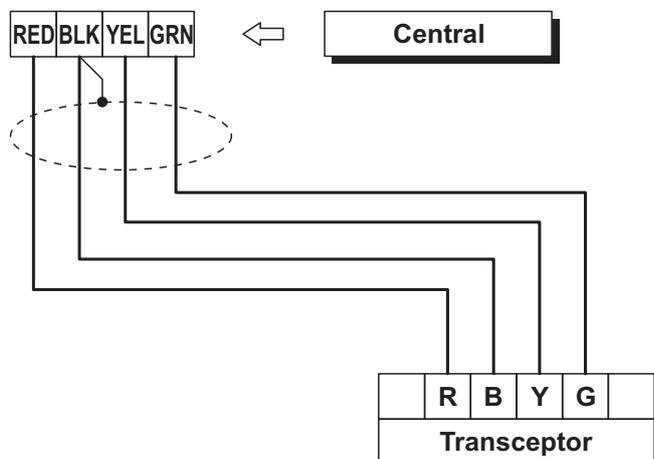
Figura 23 Conexión del transceptor a la central.
