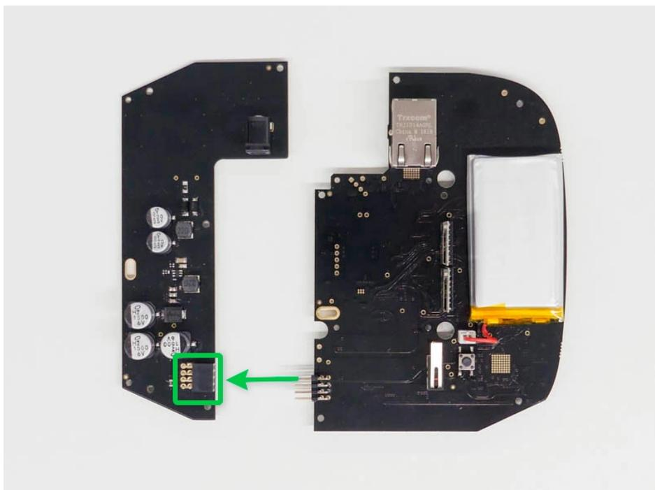
9. Vuelva a montar las placas y la carcasa del dispositivo que ajustan los tornillos.
