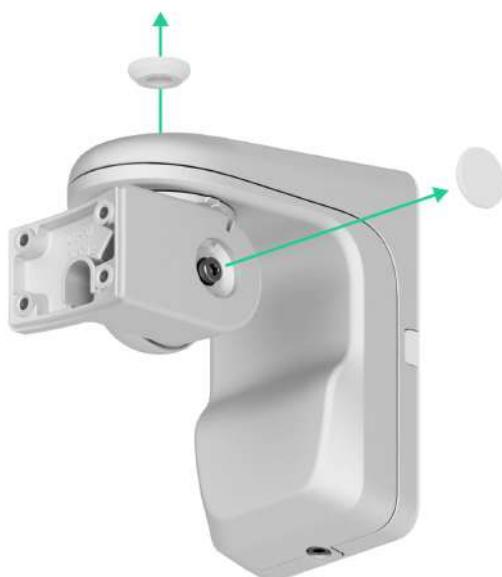
**4. Desenrosque el tornillo superior y el tornillo de fijación de la parte inferior del soporte giratorio. Desmonte la parte trasera del soporte giratorio deslizándola hacia arriba.**
