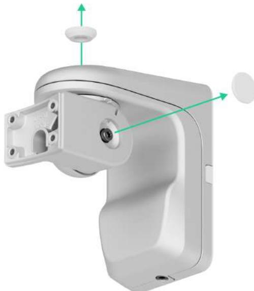
**5. Desenrosque el tornillo superior y el tornillo de fijación de la parte inferior del soporte giratorio. Desmonte la parte trasera del soporte giratorio deslizándola hacia arriba.**
