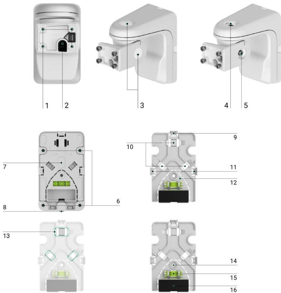
**1. Puntos de fijación para fijar el panel de montaje SmartBracket al soporte giratorio con tornillos.**
