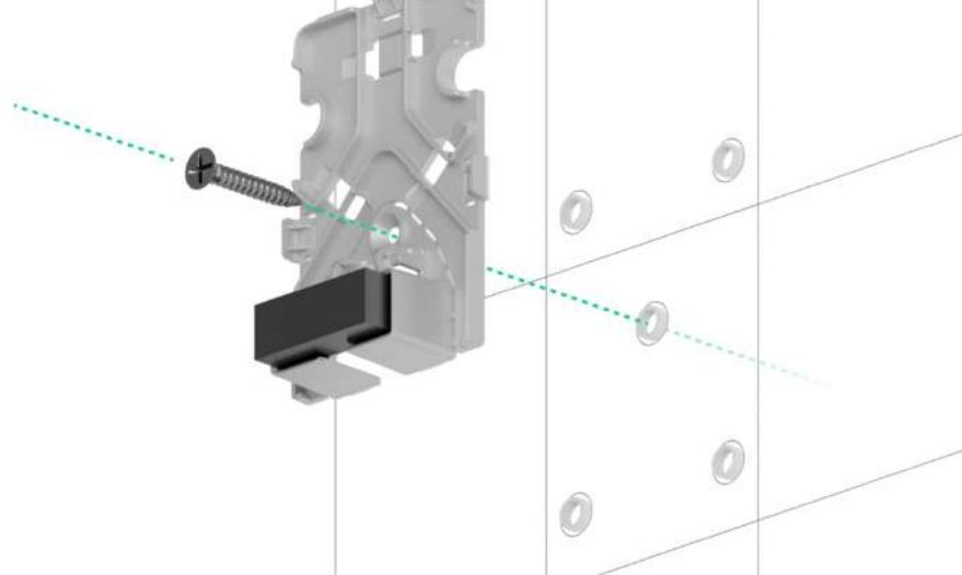
**3. Retire los tapones de estanqueidad de goma que protegen los tornillos superiores y laterales del soporte giratorio. No utilice herramientas afiladas o puntiagudas para no dañar los tapones de estanqueidad.**
