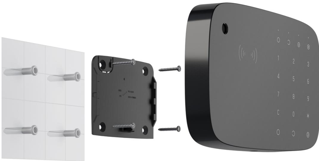
6. Deslice el KeyPad Combi sobre el panel de montaje y ajuste el tornillo de fijación en la parte inferior de la carcasa. El tornillo es necesario para que quede sujeto de manera más confiable y para proteger el KeyPad Combi contra extracciones rápidas.
