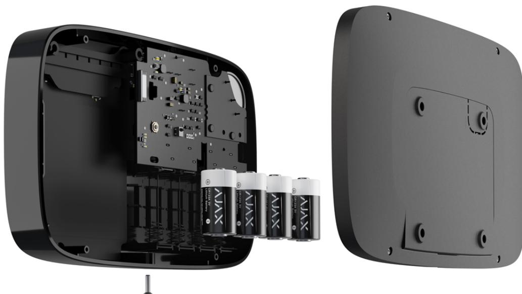
Realice pruebas de funcionamiento del KeyPad Combi con regularidad. La frecuencia óptima de las pruebas es una vez por semana. Limpie la carcasa de polvo, telarañas y otro tipo de suciedad que pueda aparecer. Utilice una serilleta suave y seca que sea adecuada para el cuidado del dispositivo.
