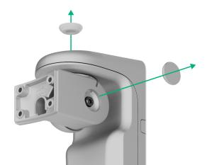
4. Desatornille el tornillo superior y el tornillo de fijación de la parte inferior del soporte giratorio. Desmonte la parte trasera del soporte giratorio deslizándola hacia arriba.
