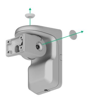
5. Desatornille el tornillo superior y el tornillo de fijación de la parte inferior del soporte giratorio. Desmonte la parte trasera del soporte giratorio deslizándola
