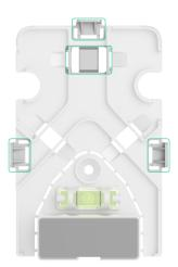
4. Retire los tapones de estanqueidad de goma que protegen los tornillos superiores y laterales del soporte giratorio. No utilice herramientas afiladas o puntiagudas para no dañar los tapones de estanqueidad.
