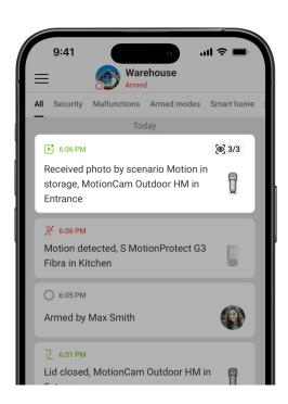
La función de Foto por escenario permite crear un escenario para los detectores de movimiento con fotoverificación. Estos detectores tomarán fotos en caso de alarmas de dispositivos Ajax especificados.
