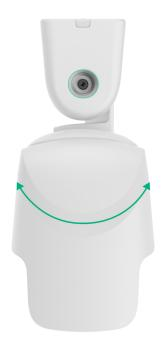
13. Afloje el tornillo lateral del soporte giratorio, ajuste el ángulo de inclinación del detector y luego, apriete el tornillo lateral.
