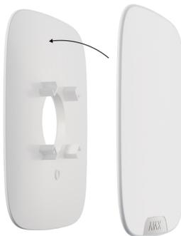
**7.** Fije el Brandplate al panel protector de plástico utilizando el tornillo del kit.
