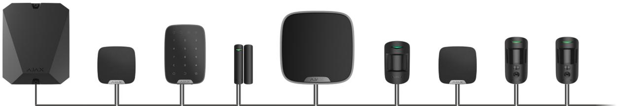
La **topología en anillo** ocupa dos salidas de línea del hub. En el caso de que se rompa el anillo en un punto, no se desactivará ni un solo dispositivo. Se formarán dos líneas que seguirán funcionando como siempre. Los usuarios y la compañía de seguridad recibirán una notificación sobre la ruptura de la línea.
