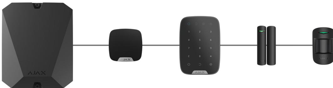
Al utilizar la topología **en serie**, asegúrese de instalar una resistencia de terminación de 120 Ohm al final de la línea (está incluida en el kit completo del hub). Esta se conecta a los terminales de señal del último dispositivo en la línea.
