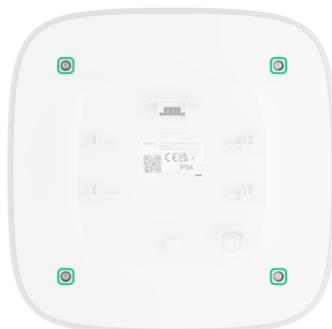
4. Dé vuelta a la sirena, sosteniendo los paneles frontal y trasero de la carcasa. Retire el panel protector de plástico.
