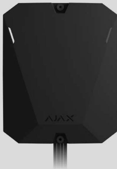
**El Superior Hub Hybrid 2 es un panel de control híbrido para un sistema Ajax, compatible con dispositivos Ajax inalámbricos y cableados. Controla el funcionamiento de los dispositivos conectados e interactúa tanto con un usuario como con una empresa de monitorización. El panel de control también está disponible como placa sin carcasa. Esta versión se llama Superior Hub Hybrid 2 (without casing).**
