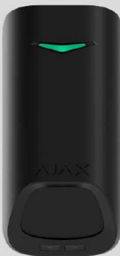
**El Superior MotionProtect G3 Jeweller es un detector inalámbrico de movimiento. Detecta el movimiento a una distancia de hasta 15 m y cuenta con un sistema antienmascaramiento que detecta los intentos de bloquear el campo de visión del detector. El dispositivo está diseñado para su instalación solo en interiores y cumple los requisitos de la norma EN 50131 (Grade 3).**
