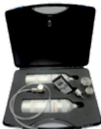
**Kit de calibración para detectores de gas**
