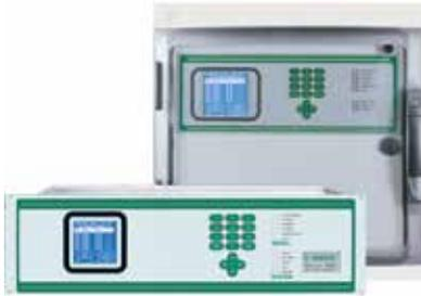
Las centrales MULTISCAN++ pueden monitorizar y controlar 64, 128 o hasta 256 detectores de gas según modelos. Extremadamente flexible, permite la supervisión tanto de detectores de gas con salida de 4-20mA como mediante transmisión digital direccionable RS485
