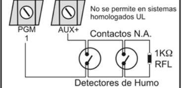
Al usar detectores de humo ESL con función CleanMe™, no conectar más de 20 detectores en paralelo.
