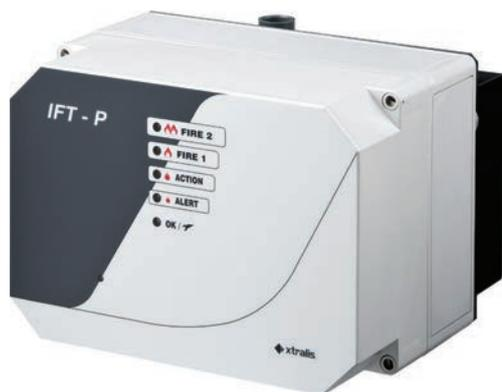
El detector ICAM IFT-P es un sistema de muestreo de aire con un rango de sensibilidad de alarma del 0,01 % al 20 % de Obs/m (oscurecimiento por metro). Se ha clasificado como un "detector de humo de aviso muy temprano" capaz de detectar incendios eficazmente en su etapa inicial, y diferentes concentraciones de humo, en superficies de hasta 2000 m<sup>2</sup>.
