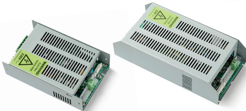
INIM dispone de dos alimentadores/cargador de baterías con la tecnología de conmutación: el modelo a 3A y el modelo de 5A. Todos los modelos están equipados con una entrada para la sonda térmica. Este dispositivo protege las baterías contra el sobrecalentamiento y el consecuente daño, mediante la medición de la temperatura de las baterías y la consiguiente regulación de la tensión de las mismas.
