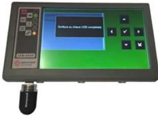
Cuando el procedimiento ha finalizado, en la pantalla del panel se visualiza el mensaje «**Guardado en memoria USB completado**».
