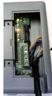
Colocar el cable de llegada en la caja de bornes CNU. Fijar el cable de llegada con una brida sujetacables.
