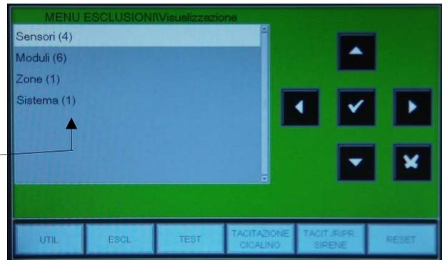
Para visualizar las listas de dispositivos anulados, seleccionar con las teclas flecha **▲ ▼** el tipo de dispositivo, a continuación, pulsar la tecla de envío
