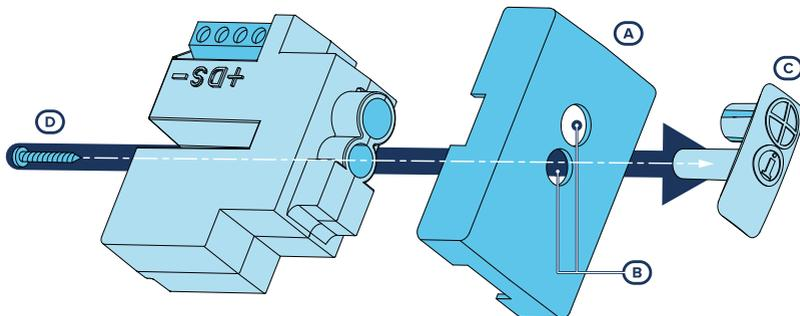
El lector nBy/X ha sido diseñado para insertarse en un contacto empotrable de pared. Se puede aplicar a cualquier tapón de contacto [A], practicando dos orificios [B] donde incluir la guía luz [C].
