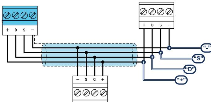
Los periféricos de las centrales Inim Electronics se conectan a la unidad central a través del I-BUS. La conexión entre la central y sus periféricas se produce con un cable blindado de 4 (o más) cables.
