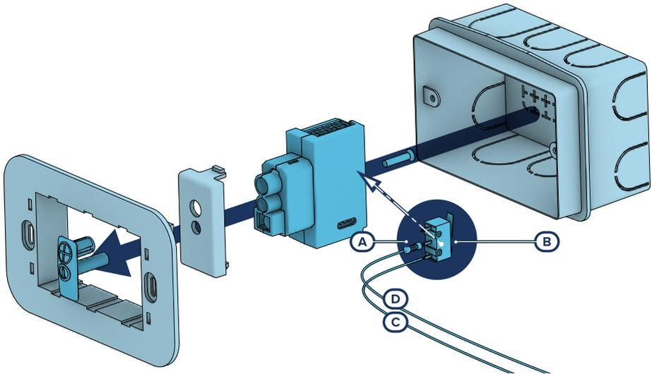
Los periféricos con los terminales visibles y que no tienen una protección antisabotaje pueden equiparse con una protección interviniendo en el procedimiento de montaje.
