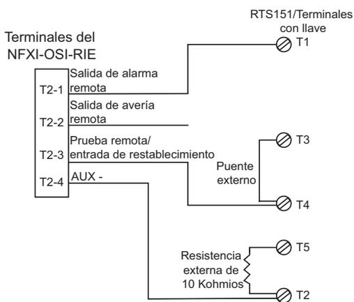
Cableado: Cable simple de 2 pares, 0,8 mm<sup>2</sup>, sin blindaje.
