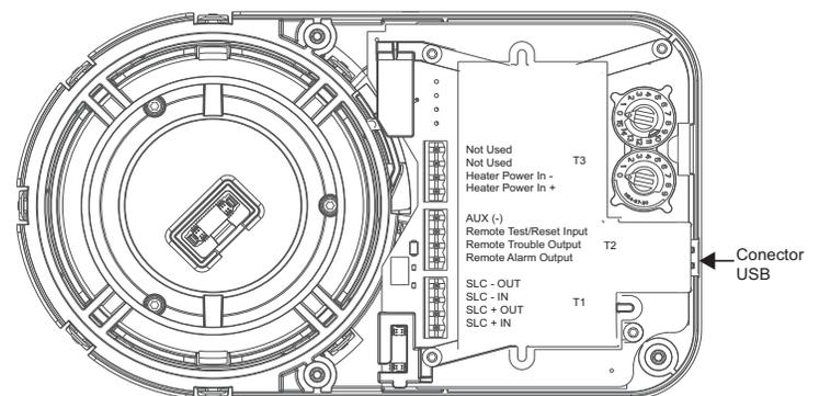
Figura 3-11: Conexiones de cableado en el detector
