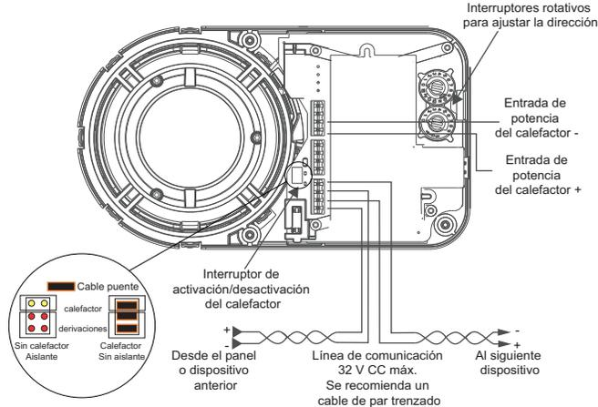
Figura 3-12: Diagrama de cableado
