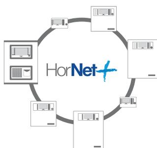
Para aumentar la extensión de la instalación pueden conectarse en red varias centrales Previdia Max y Previdia Compact (hasta un máximo de 48 puntos entre las centrales y el repetidor), de manera que se construya un sistema de mayor capacidad (red HorNet+).
