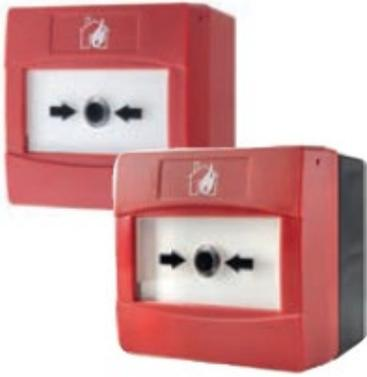
Pulsador manual direccionable con la membrana rearmable. Diseñado para accionar la alarma manual en un sistema de alarma contra incendios. Hay dos modelos disponibles MCPSC-NT y WCPSC-NT. Ambos pulsadores están equipados con un aislador e incluyen un módulo direccionable con protocolo CLIP que permite la interconexión con las centrales NOTIFIER. Ambos modelos cuentan con la certificación CPR según las normas EN54-11, EN54-17.
