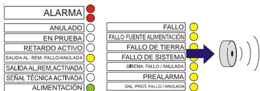
La central dispone de un zumbador interno que proporciona aviso local cuando se detecta una de las siguientes condiciones:
