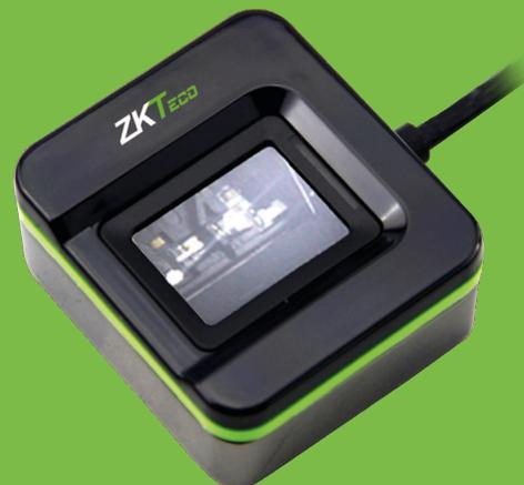
SLK20R es un potente sensor de huellas digitales diseñado por el laboratorio de ZKTeco en Silicon Valley, Estados Unidos el cual adopta un avanzado diseño óptico.
