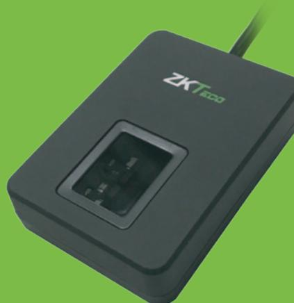
ZK9500, es el último escáner óptico de huellas digitales, desarrollado por ZKTeco. El escáner realiza la detección de dedos y captura la imagen de la huella digital rápidamente y con alta resolución.
