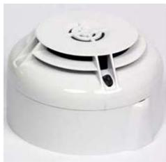
Il sensore ottico di fumo NRX-OPT è un dispositivo a radiofrequenza alimentato a batteria, progettato per essere impiegato con il gateway radio NRXI-GATE. Contiene un ricetrasmittitore e viene integrato
