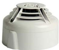
Il rivelatore di calore a soglia fissa a 58°C NRX-TFIX58 è un dispositivo a radiofrequenza alimentato a batteria, progettato per essere impiegato con il gateway radio NRXI-GATE. Contiene un ricetrasmittitore e
