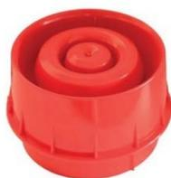
La sirena radio NRX-WS-RR è un dispositivo a radiofrequenza alimentato a batterie, progettato per essere impiegato con il gateway radio NRXI-GATE. Contiene un ricetrasmittitore e viene integrato in un sistema antincendio indirizzabile
