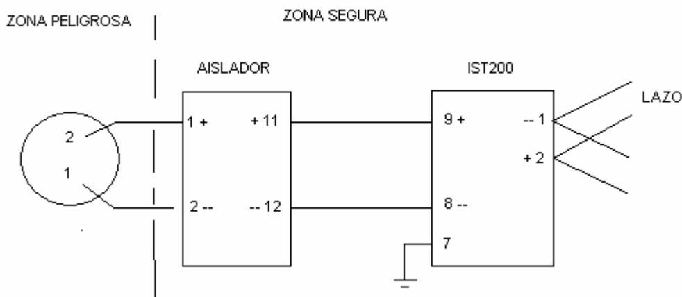
En pruebas realizadas **con una cantidad de 4 detectores analógicos** de seguridad intrínseca.
