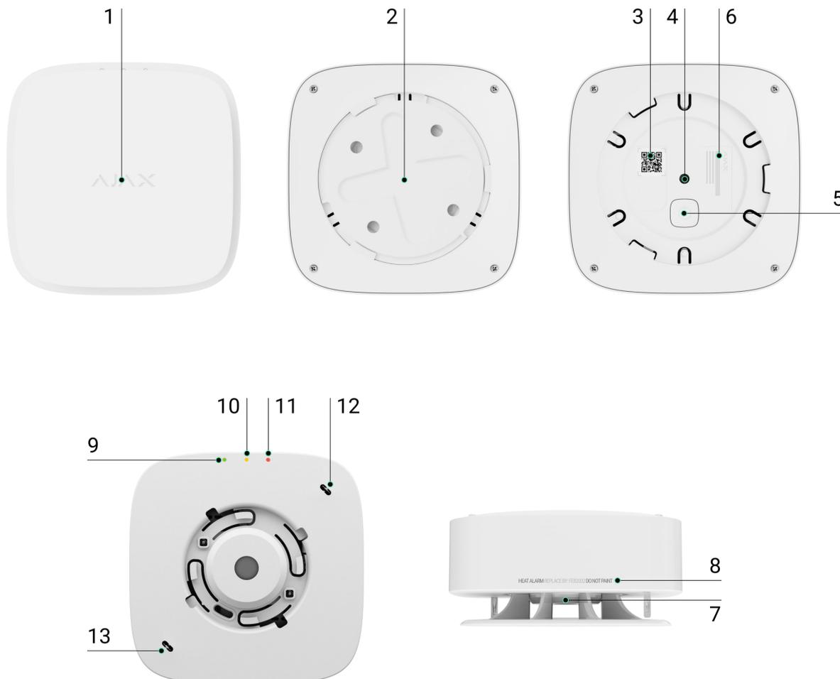
1. Panel frontal del detector con el **botón de Test/Silencio**. Para activar el botón, pulse la parte central del panel.
