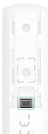
Se recomienda instalar el detector cableado a una distancia máxima de 1 metro. Aumentar la longitud del cable incrementará el riesgo de que se dañe y reduzca la calidad de la comunicación entre los detectores.
