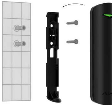
10. Apriete el tornillo de fijación en la parte inferior de la carcasa del detector para una fijación más fiable y para protegerlo contra un desmontaje rápido.
