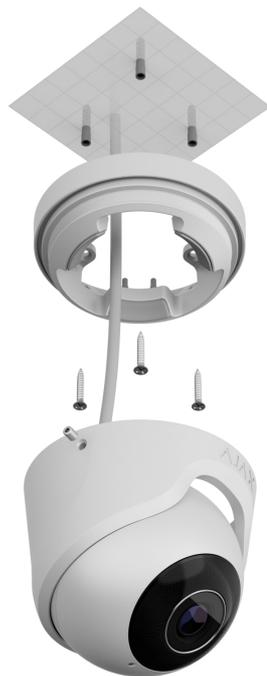
5. Coloque la carcasa de la cámara en el soporte, de manera que la lente de la cámara esté dirigida hacia la zona protegida. Fíjela apretando los dos
