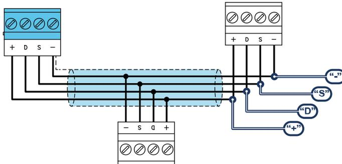
Los periféricos de las centrales Inim Electronics se conectan a la unidad central a través del I-BUS.
