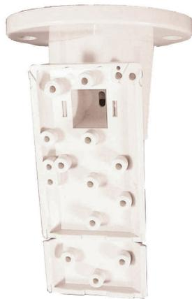
Montaje en techo del soporte de plástico giratorio para montaje en techo B338. Adecuado para su uso con varios detectores. El rango de giro vertical es de  $+7^{\circ}$  a  $-16^{\circ}$ ; el rango de giro horizontal es de  $\pm 45^{\circ}$ .
