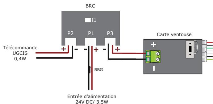
Le boîtier BRC est indispensable à la conformité NFS61-937 et doit être réarmé en appuyant sur le bouton I1 situé à l'intérieur du boîtier.
