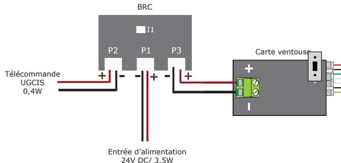
Le boîtier BRC est indispensable à la conformité NFS61-937 et doit être réarmé en appuyant sur le bouton I1 situé à l'intérieur du boîtier.
