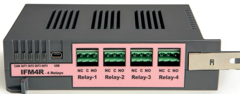
Módulo interno para la gestión de 4 relés programables para centrales de detección de incendios Previdia Max. Las centrales Previdia Max pueden gestionar hasta un máximo de 16 módulos IFM4R. El módulo IFM4R pone a disposición 4 salidas con relé con contactos libres de potencial. La activación de cada uno de los relés se puede definir en el momento de la configuración del equipo, utilizando el software de configuración.
