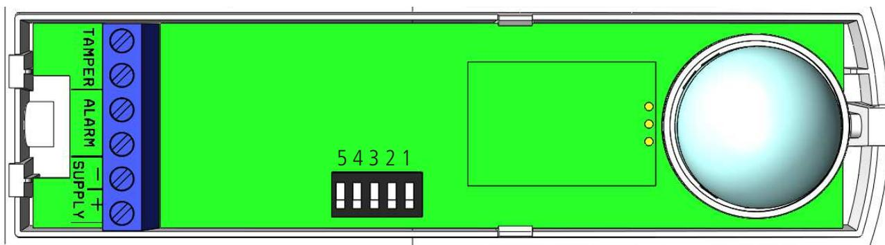
**TAMPER:** LINEA TAMPER ANTIAPERTURA - 400mA 40Vdc
