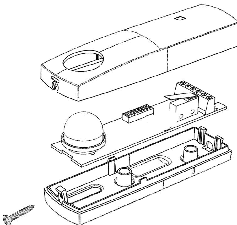
Fissata la base posteriore fare scorrere il cavo nei fori scelti, fissare la scheda nella propria sede ad incastro e fissare i cavi negli appositi terminali, chiudere la cover superiore e bloccare il tutto con la vite in dotazione (fig.)
