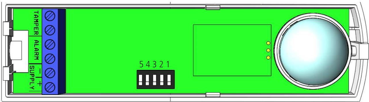
**TAMPER:** TAMPER ANTIOPENING LINE - 400mA 40Vdc
