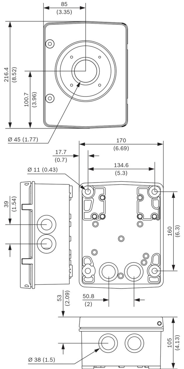
Fig. 2: NDA-U-PA0 Surveillance cabinet 24VAC
