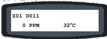
**6.- Seleccionar “Concentración”** para leer la concentración de ppm y Temperatura en °C de cada sensor. El número del sensor aparece en pantalla y el correspondiente sensor parpadea en color verde.
