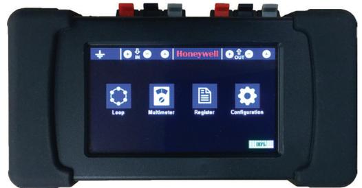
*El POL-200-TS es una herramienta gráfica compacta y portátil. Ayuda al instalador en la programación y pruebas de lazo en obra, antes de iniciar la instalación y puesta en marcha de los sistemas de detección y alarma de incendios de Notifier, Morley, System Sensor o Honeywell.*
