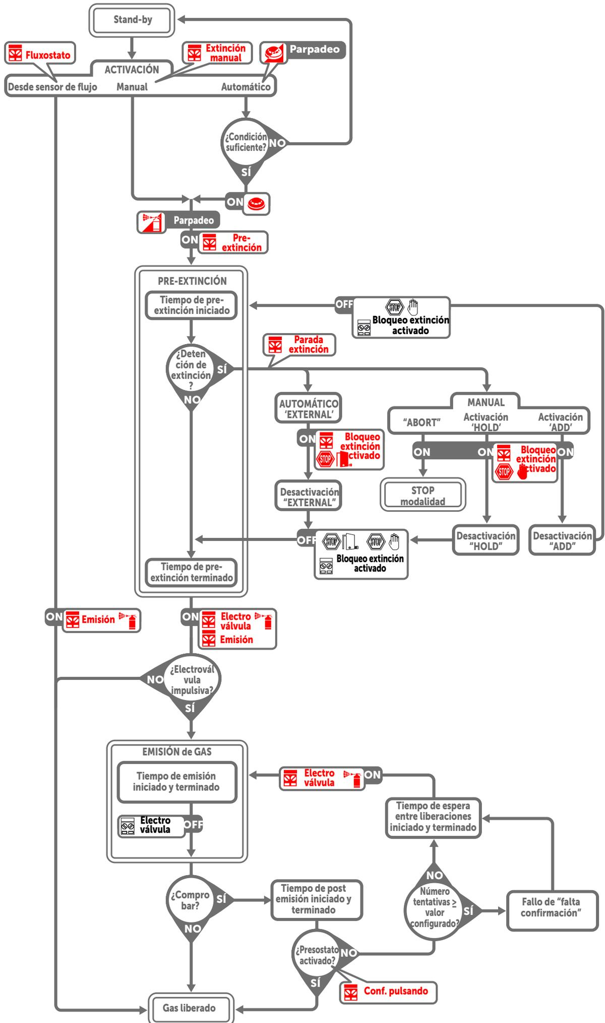
En la siguiente tabla se describen las funciones asociadas a la extinción que pueden programarse para las entradas y salidas de la central (incorporadas o en loop, mediante salidas supervisadas como por ejemplo las de los módulos EM312SR).
