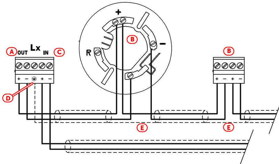
En la conexión de los dispositivos en loop no tiene importancia mantener el orden de entrada/salida mostrado en la figura.
