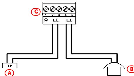
Conectar la línea telefónica [A] a los bornes "L.E." y el aparato telefónico o la línea interna [B] a los bornes "L.I." de la placa [C], párrafo 2.4 - [B]).
