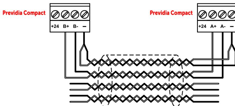
**Cables:** Si el cable se utiliza para alimentar repetidores, se debe evaluar adecuadamente la sección de los conductores utilizados para la alimentación.
