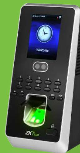
El MultiBio 800-H es un equipo multibiométrico de alta capacidad para el control de acceso y gestión del tiempo y asistencia con verificación de rostro y huella. Integrado con el último algoritmo ZKFace 7.0 que incorpora un veloz reconocimiento de rostro y una baja probabilidad de fallo.
