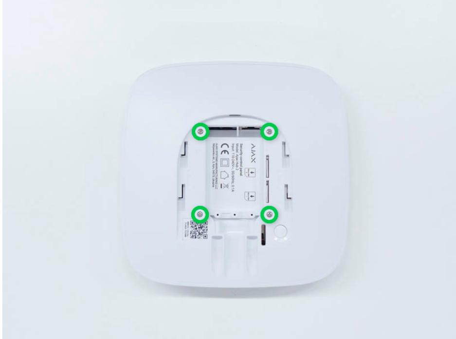
5. Retire los tornillos que sujetan las placas a la carcasa del dispositivo.
