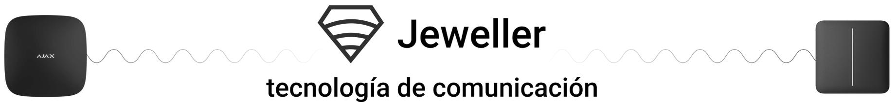
**Jeweller** es un protocolo de radio para una comunicación bidireccional, rápida y fiable entre el hub y dispositivos conectados. El protocolo proporciona un alcance de comunicación inalámbrica de hasta 1.100 m, lo que permite instalar interruptores no solo en pisos y casas privadas, sino también en un espacio de oficinas o almacén grandes.
