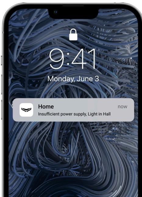
El LightSwitch comprueba continuamente los parámetros de su alimentación. Si el LightSwitch controla la potencia de un dispositivo de iluminación de potencia insuficiente (hasta 7 W), el sistema notificará a los usuarios del sistema Ajax. En este caso, es necesario reemplazar el dispositivo de iluminación por uno igual con mayor capacidad o conectar un condensador incluido en el kit en paralelo con el dispositivo de iluminación.
