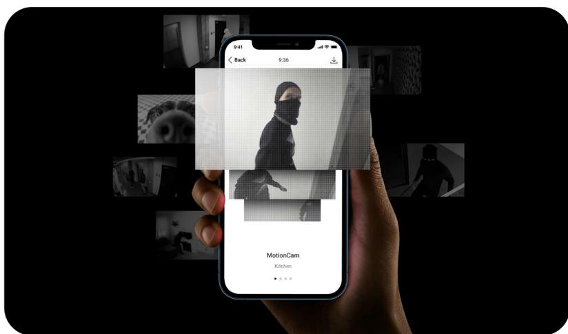
El detector está equipado con una cámara integrada y envía las fotos animadas a la compañía de seguridad y a los usuarios. El dispositivo admite tres tipos de verificación fotográfica: por alarma, por escenario y bajo demanda. La fotoverificación permite evaluar la situación en la instalación protegida, comprobar si la alarma es real y reaccionar adecuadamente.
