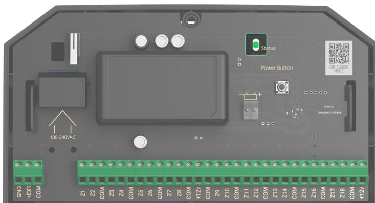
El indicador LED MultiTransmitter puede encenderse en blanco, rojo o verde, según el estado del dispositivo. Tenga en cuenta que el indicador LED no es visible cuando el tamper está cerrado, pero puede verificar el estado del dispositivo en la app Ajax.
