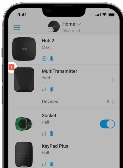
Si se detecta el mal funcionamiento de MultiTransmitter (por ejemplo, la pérdida de conexión con el hub a través de Jeweller), la app Ajax muestra un contador
