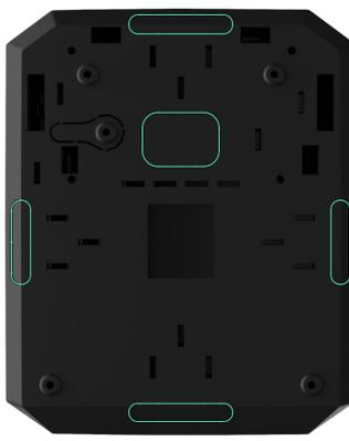
2. Sujete la carcasa sobre la superficie vertical en el lugar de instalación seleccionado con los tornillos empacutados utilizando todos los puntos de fijación. Uno de ellos está en la parte perforada encima del interruptor antisabotaje, y es necesario para que se active en caso de cualquier intento de extraer la carcasa de MultiTransmitter de la superficie.
