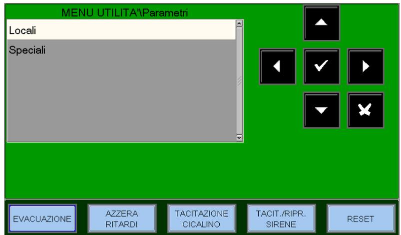
**Locales :** para modificar la función **Parpadeo LED**, pulsar la tecla de confirmación  y utilizar las teclas flechas  $\uparrow$   $\downarrow$  para modificar el parámetro; al finalizar pulsar la tecla  confirmación para confirmar. Seleccionando NO, la función de parpadeo del LED, durante la consulta, se desactivará para todos los puntos instalados. La desactivación del parpadeo LED puede realizarse para un punto individual (ver el párrafo de programación sensores y módulos).
