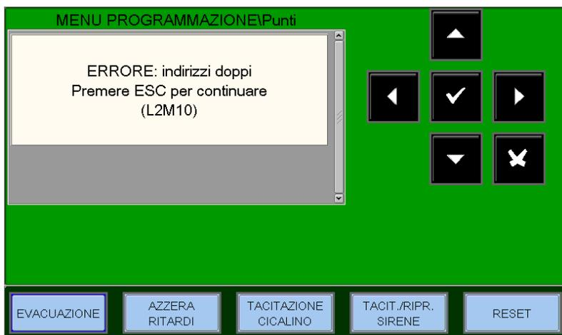
Cuando se encuentran más dispositivos programados con la misma dirección, la pantalla muestra el mensaje de error representado junto con la indicación de la dirección.
