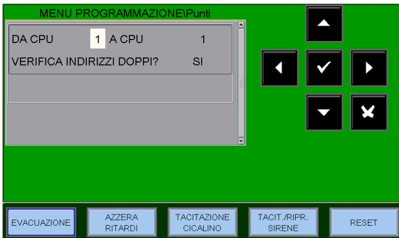
Para introducir el número de CPU utilizar las teclas flecha  y confirmar con confirmación
