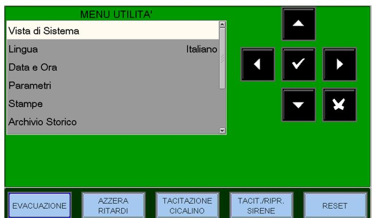
**Vista del sistema:** con esta utilidad es posible visualizar todos los periféricos y todos los dispositivos configurados en el sistema.
