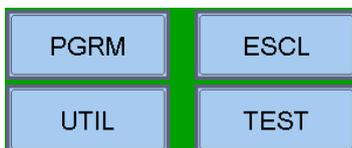
Estas teclas se visualizan en la parte inferior del LCD. Activan la función correspondiente. Las funciones cambian con los menús seleccionados. Por ejemplo: en el menú **estado de la instalación** estas teclas permiten el acceso a las funciones de: Programación, Utilidades, Anular o Prueba (TEST).
