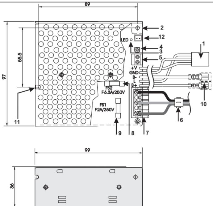
Fig. 1 - Identificazione delle parti - Identification of parts - Identificación de los componentes - Identification des Pièces
