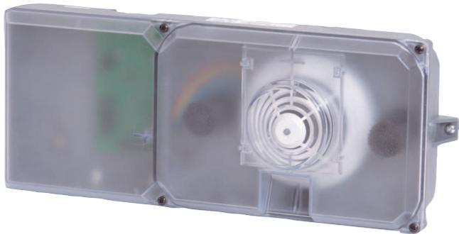
La carcasa de detector para conductos FAD-420-HS-EN con base y detector FAD-425-O-R integrado detecta el humo en los conductos de ventilación. Las partículas de humo se detectan de forma fiable y esto se comunica a la central de incendios mediante un sistema de bus LSN mejorado.
