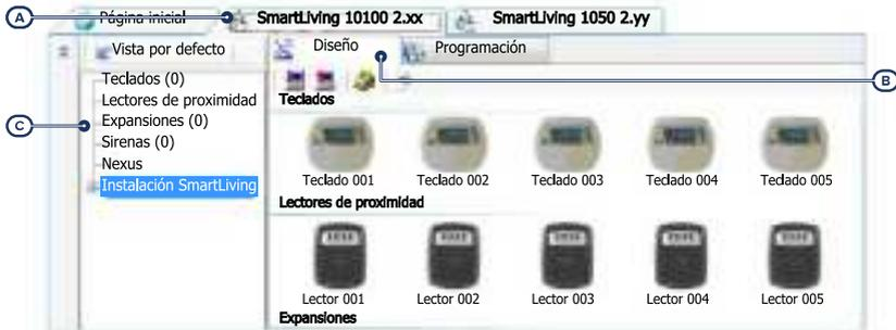
Una vez abierta la solución de la instalación por diseñar [A], en la pestaña derecha «Diseño» [B], se puede seleccionar un icono del tipo de periférico por configurar y arrastrarlo a la parte correspondiente de la estructura de árbol de la izquierda [C].
