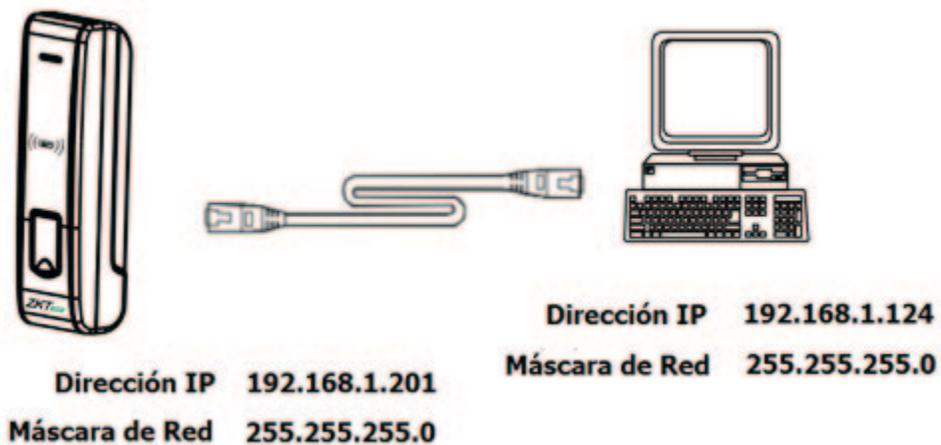
b) **Cable recto:** El dispositivo y la PC conectados a LAN/WAN mediante Switch/Landswitch.
