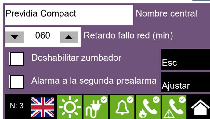
Mediante el botón **Esc** es posible salir de la sección sin guardar los cambios de configuración, mientras que mediante **Ajustar** se guardan los cambios.
