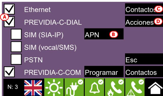
El botón **APN** [B] permite acceder a una sección para configurar los parámetros necesarios para la conexión a la red celular.
