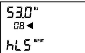
**BYPASS - RANGO DE FRECUENCIA DE ENTRADA PARA BYPASS:**
