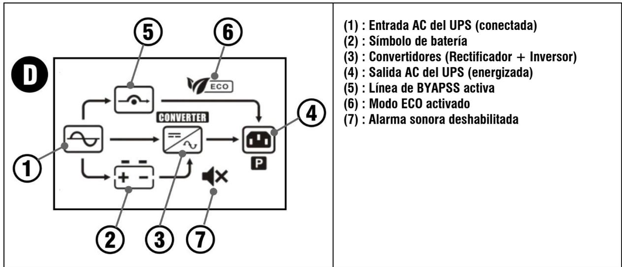
**POTENCIA ENTREGADA POR EL UPS EN SUS SALIDAS (CARGA CONECTADA A LA SALIDA DEL UPS)**
