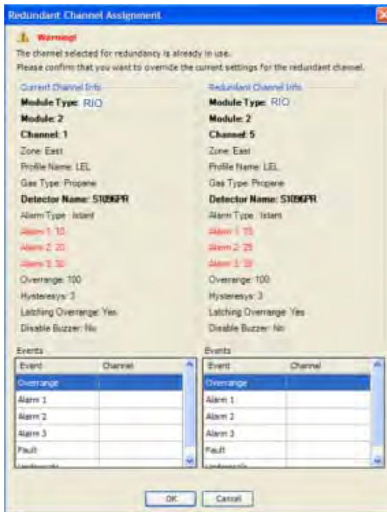
Fig. 4.5.5 g) Pantalla de aviso que aparece cuando se selecciona un canal redundante que ya estaba definido pero con parámetros diferentes
