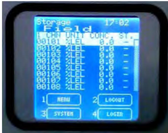
Fig. 3.2.1 a) Pantalla típica de estado NORMAL
