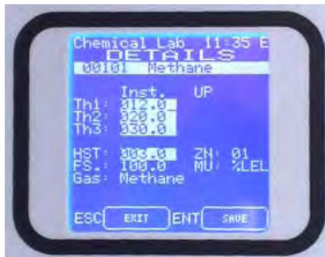
Fig. 3.8.3 a) Detalles del detector seleccionado desde el nivel de Técnico ("E")
