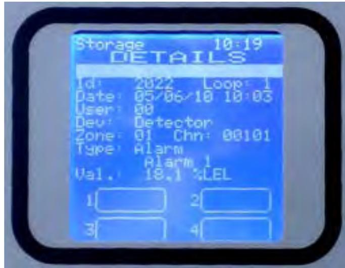
Fig. 3.2.1.c) Pantalla con los detalles de Alarma.
