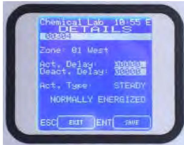
Fig. 3.8.3 b) Pantalla con detalles del relé seleccionado desde el nivel Técnico ("E")
