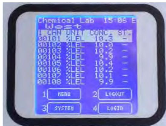
Fig. 3.7 b) Pantalla de estado NORMAL con la letra "E" (nivel de acceso TÉCNICO) en la parte superior derecha de la pantalla
