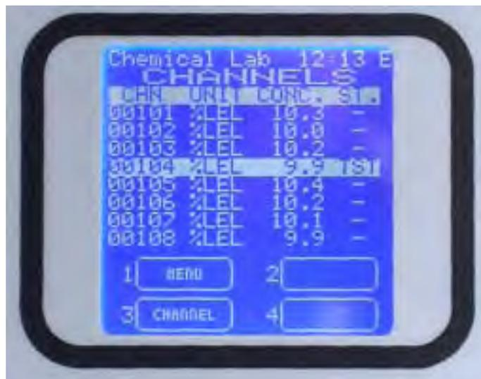
Fig. 3.8.4 a) Pantalla con un canal en TEST (prueba)
