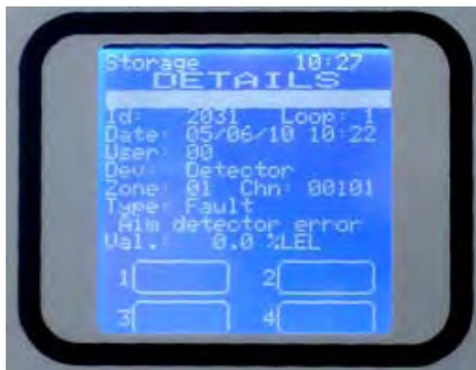
Fig. 3.2.1.e) Pantalla con los detalles de Avería (*Fault*).
