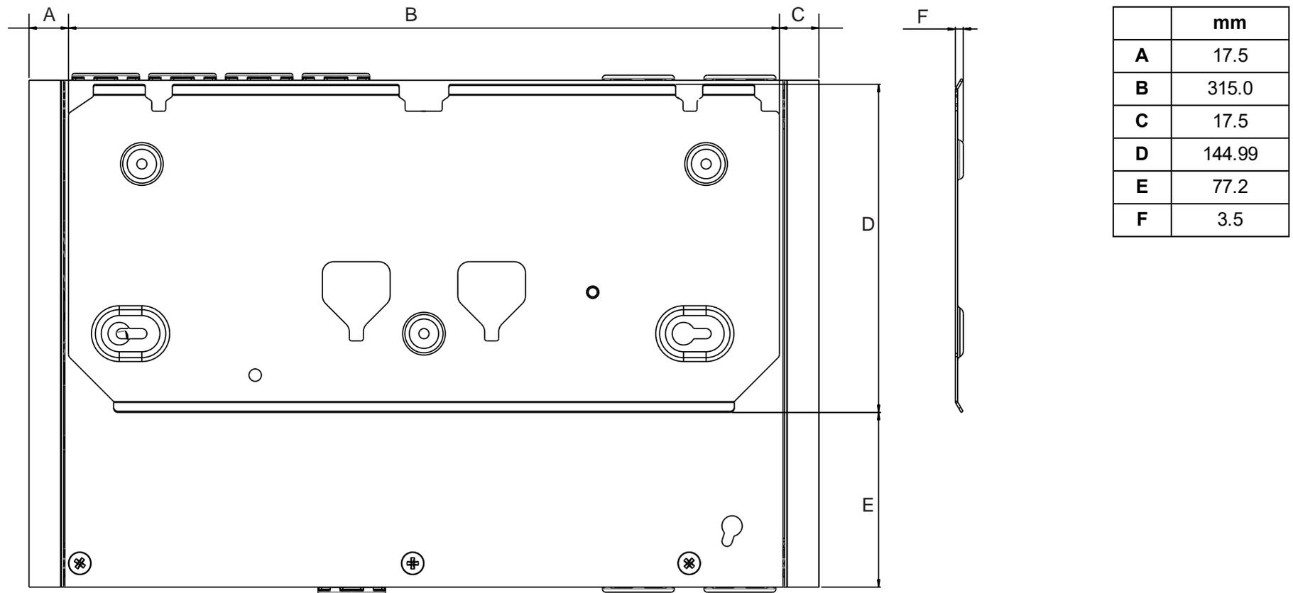
Figura 2-5: Dimensiones de la parte posterior con el soporte de montaje
