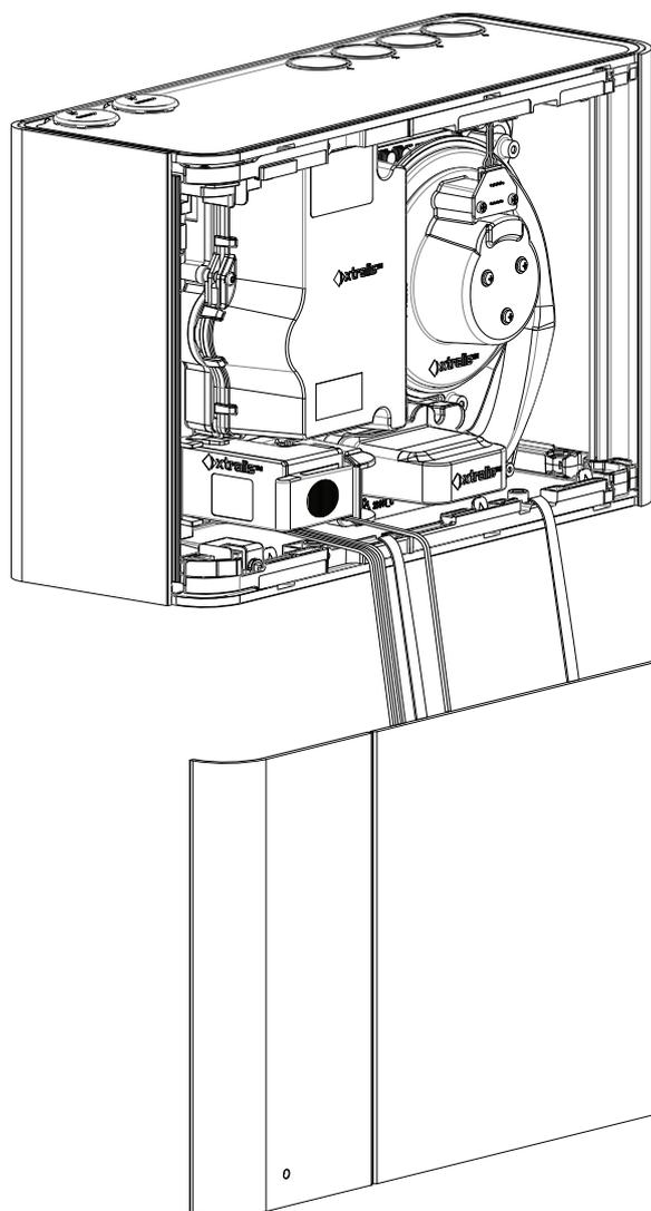
Figura 7-9: Placa protectora colgando de las dos sujeciones
