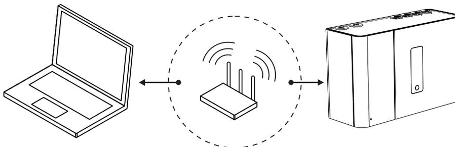
Figura 5-10: Conexión a un detector a través de WiFi mediante un enrutador
