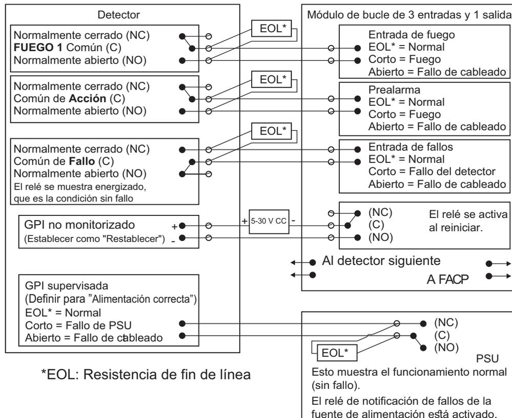
Figura 4-38: Módulo de circuito de entrada/salida con FDL
