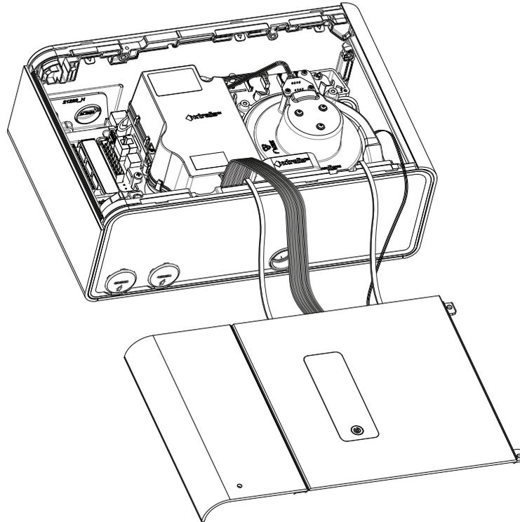
Figura 4-5: Detector con la placa protectora extraída
