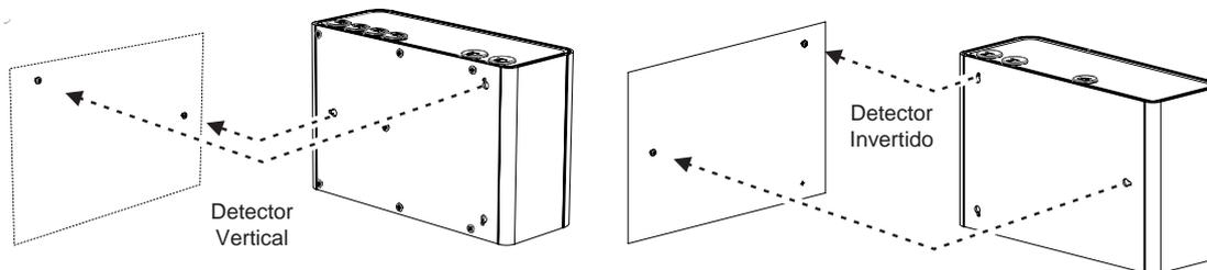
Figura 4-26: Montaje del detector
